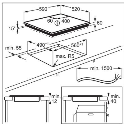
Αν χρησιμοποιείτε προστατευτικό πλαίσιο (ένα πρόσθετο εξάρτημα), δεν χρειάζεται να αφήσετε χώρο ροής αέρα 2 mm στο μπροστινό μέρος, ούτε να χρησιμοποιήσετε προστατευτικό πάτο κάτω από τις εστίες. Το προστατευτικό πλαίσιο ενδέχεται να μην είναι διαθέσιμο σε ορισμένες χώρες. Επικοινωνήστε με τον πωλητή της περιοχής σας.
