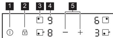
Brug sensorfelterne til at betjene apparatet. Display, kontrollamper og signaler viser de funktioner, der er i brug.
