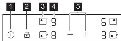
Ракувајте со апаратот со помош на сензорските полиња. Екраните, показателите и звуците покажуваат кои функции работат.
