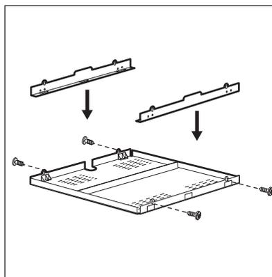
Dacă folosiți o cutie de protecție (accesoriu suplimentar), nu sunt necesare spațiul frontal de 2 mm pentru fluxul de aer și podeaua de protecție direct sub plită. Cutia de protecție nu este disponibilă în toate țările. Contactați furnizorul.
