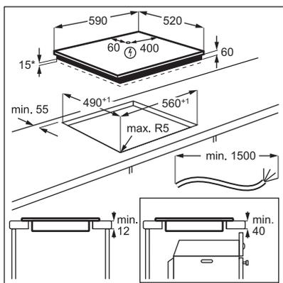
Om du har en skyddslåda (extra tillbehör) behövs inte det främre luftflödesutrymmet på 2 mm och skyddsgolvet direkt under hällen. Skyddslådan (tillbehör) finns inte i alla länder. Kontakta din lokala återförsäljare.
