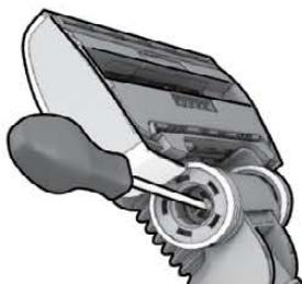
**3.** Csavarozza ki a keréktengelyt, és tisztítson meg minden alkatrészt. Az összeszereléshez végezze el a fenti műveleteket fordított sorrendben.
