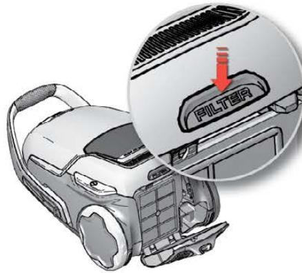
3. لفتح غطاء الفلتر قم بالضغط على زر FILTER أسفل المكنسة. يرجى استخدام فلتر Electrolux الأصلي: EFS 1W / EFH 12W.
