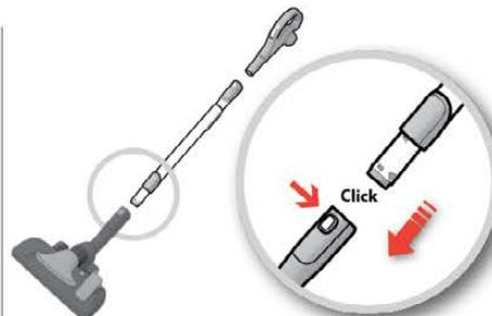
**3. Podłącz rurę teleskopową do ssawki podłogowej (aby ją odłączyć, naciśnij przycisk blokujący i wyciągnij ssawkę).**
