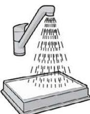
**5. Čistení umývatelného výstupního filtru.** Opláchněte vnější (znečištěnou) stranu filtru vlažnou vodou. Poklepejte na rám filtru, aby voda odtekla. Tento postup opakujte čtyřikrát.
