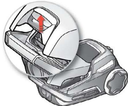
**3. Poklopac spremnika za prašinu otvorite pritiskom na tipku S-BAG.****1. Modeli z digitalnim zaslonom: Vrečko za prah morate zamenjati, ko zasveti indikatorska lučka s-bag®.\*****2. Modeli z mehaničkim indikatorjem:**
