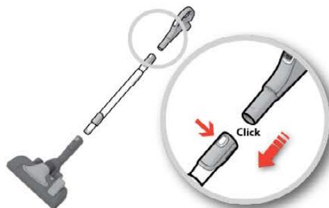
**4. Podłącz rurę teleskopową do uchwytu węża (aby ją odłączyć, naciśnij przycisk blokujący i wyciągnij uchwyty węża).**
