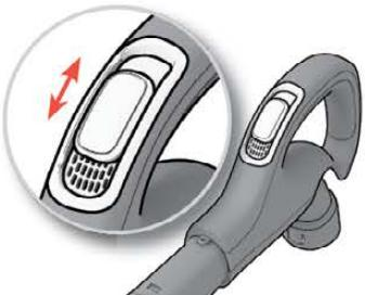
На моделях с ручным управлением воздушный клапан позволит быстро снизить мощность всасывания.
