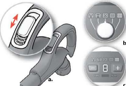
**9. Állítsa be a szívóteljesítményt.** Kézi vezérlésű modellek. a) A szívőrő gyors csökkentéséhez használja a levegőszelépet b) A szívóteljesítmény beállításához használja a porszívón lévő forgatógombot c) A szívóteljesítmény beállításához használja a porszívón elhelyezett + vagy - gombot.
