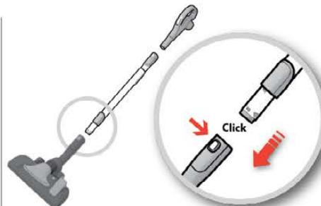
**3. Csatlakoztassa a teleszkópos csövet a szívőfejhez** (eltávolításához nyomja meg a rögzítőgombot, majd húzza ki a szívőfejet).
