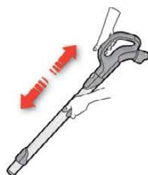
**5. Namjestite teleskopsku cijev tako što ćete jednom rukom držati gumb za zaključavanje, a drugom izvući ručku.**
