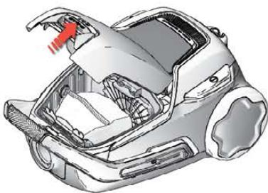
**1.** Откройте крышку отсека для сбора пыли, нажав на кнопку «S-BAG» и потянув крышку вверх. **Проверьте наличие пылесборника s-bag®.**
