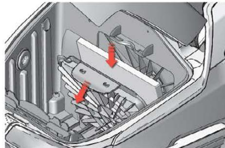
**8.** Заменяйте фильтр двигателя при загрязнении или с каждым пятым пылесборником s-bag®. Нажмите на держатель фильтра и выньте его. Замените фильтр и закройте крышку.
