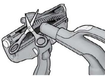
**2.** Wyjmij szczotkę rolkową i usuń zaplątane nitki i włókna, przecinając je nożyczkami. Oczyść ssawkę, używając uchwytu węza. Włóz części z powrotem, wykonując te czynności w odwrotnej kolejności.
