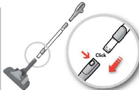
**3. Pričvrstite teleskopsku cijev na podnu sapnicu (da biste je uklonili, pritisnite gumb za zaključavanje i izvucite je).**
