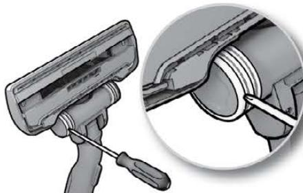
**2. Если колеса застревают, очистите их, сняв крышки небольшой отверткой.**
