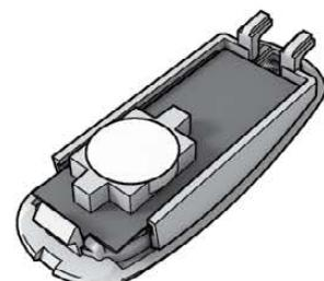
**2. Używaj tylko baterii typu LITHIUM CR1632.** Przed utylizacją odkurzacza baterie muszą być usunięte. Należy zadbać o ich bezpieczną utylizację.
