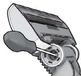
**3.** Odkręć oś i oczyść wszystkie części. Włóz części z powrotem, wykonując te czynności w odwrotnej kolejności.
