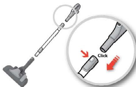
**4. Csatlakoztassa a teleszkópos csövet a gégecső fogantyújához** (eltávolításához nyomja meg a rögzítőgombot, majd húzza ki a gégecső fogantyúját).
