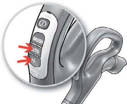
**10. Отрегулируйте мощность всасывания. Модели с дистанционным управлением.** Пылесос запускается в авторежиме (автоматическое управление мощностью). Для ручной регулировки нажмите кнопку “-” (минимум) или кнопку “+” (максимум). Для возврата в авторежим нажмите кнопку AUTO.
