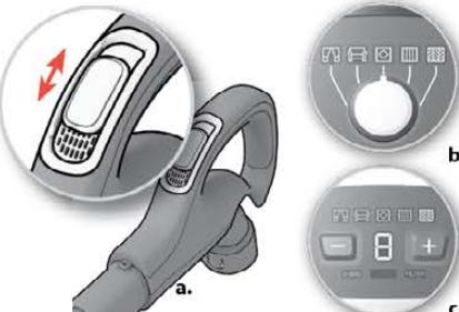
**9. Отрегулируйте мощность всасывания.** Модели с ручной регулировкой. а) Для быстрого ослабления воздушного потока воспользуйтесь воздушным клапаном на ручке. б) Воспользуйтесь поворотной ручкой на пылесосе для регулировки мощности всасывания. в) Воспользуйтесь кнопками «+/-» для регулировки мощности всасывания.
