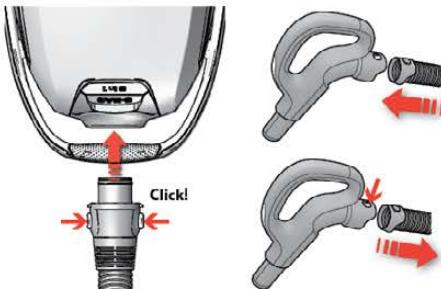
**2. Podłącz wąż do odkurzacza (aby go odłączyć, naciśnij przyciski blokujące i wyciągnij wąż).**
