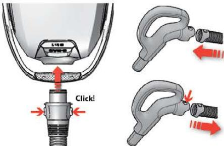
**2. Csatlakoztassa a tömlöt a készülékhez** (eltávolításához nyomja meg a rögzítőgombokat, majd húzza ki a gégecsővet).
