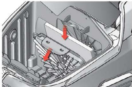
**8. Zamijenite filter motora kad se zaprija ili nakon svake pete zamjene vrećice s-bag®**. Gurnite držać filtra prema dolje i izvucite ga. Zamijenite filter i zatvorite poklopac.
