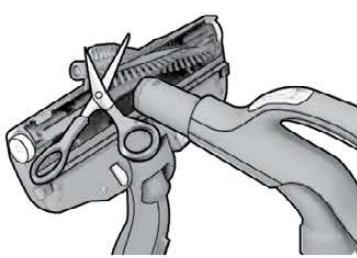
**2.** Húzza ki a forgókefét, és ollóval távolítsa el a rácsavarodott szálakat. A szívófej megtisztításához használja a gégecső fogantyúját. Az összeszereléshez végezze el a fenti műveleteket fordított sorrendben.
