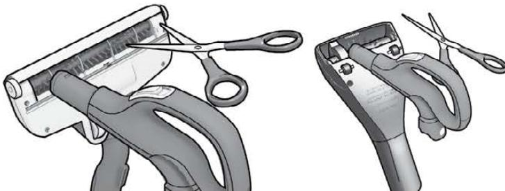
**1. Czyszczenie ssawki Turbo** (tylko niektóre modele)
