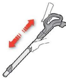
**5. Регулирайте телескопичната тръба като с едната си ръка държите натиснат бутона за заключване, докато изтеглите дръжката с другата си ръка.**
