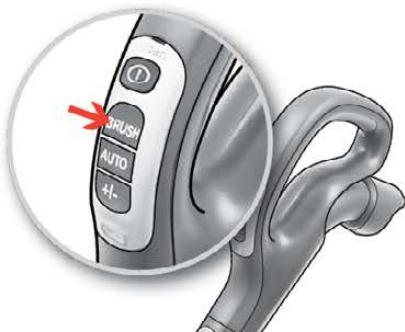
**11. Távirányítású, Aeropro motoros szívófejjel rendelkező típusok.** A motoros szívófej bekapsolásához nyomja meg a BRUSH (kefe) gombot a fogantyún.
