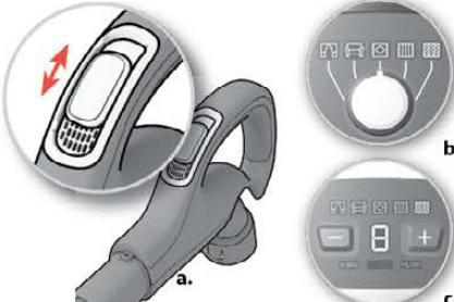
**9. Подесите јачину усисавања Модели ручном регулацијом:** а) Јачину усисавања можете брзо да подесите помоћу дугмета за регулацију јачине усисавања на ручки, б) Јачину усисавања можете да подесите помоћу ротирајућег дугмета на самом усисивачу, в) Јачину усисавања можете да подесите помоћу дугмади + и - на самом усисивачу.\*
