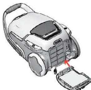
**7.** В случае ослабления фиксации крышки фильтра заново установите её, поместив крышку стороной с крюками в соответствующие пазы, затем нажмите на крышку до фиксации со щелчком.
