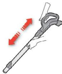
**5. Nastavte teleskopickou trubici** – jednou rukou podržte zámek a druhou zatáhněte za rukojet.
