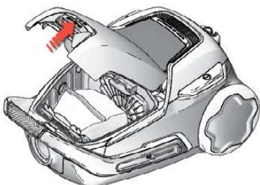
**1.** Otevřete kryt prachového oddílu zatažením za tlačítko uvolnění sáčku „S-BAG“. **Zkontrolujte, že je sáček s-bag® na svém místě.**
