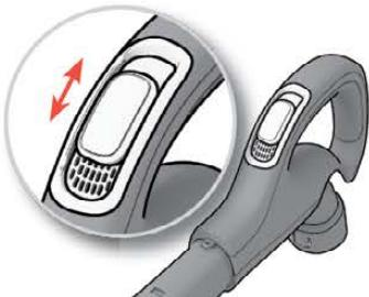
A kézi vezérlésű modelleknel a levegőszelép segítséget nyújt a szívőrő gyors csökkentésében.
