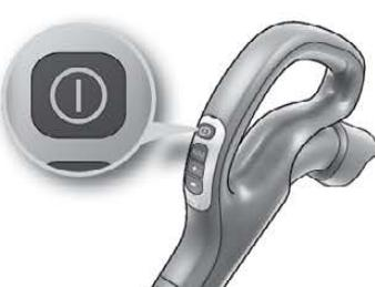
**8. Модели с дистанционным управлением также управляются кнопкой ВКЛ/Выкл на ручке.**
