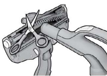
**2.** Izvucite valjak s četkom i uklonite zapletene niti režući ih škarama. Za čiščenje sapnice upotrijebite ručku crijeva. Sastavite obratnim redoslijedom.
