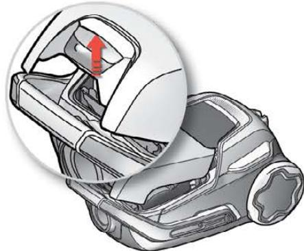
**3. Otwórz pokrywę komory worka na kurz, pociągając przycisk S-BAG.**
