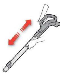
**5. Отрегулируйте телескопическую трубку**, держа замок одной рукой и вытягивая рукоятку другой.
