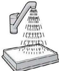
5. تنظيف الفلتر القابل للغسيل بالماء: قم بتنظيفه من الداخل (الداخنة المقفلة) بالمياه الماء من الخلية. ثم قم بتحريك الفلتر بشكل منتظم ومتكرر بعيدا عن الخلية لتصفيته من الماء. قم بتنكّار عملية التنظيف باكملها أربع مرات.
