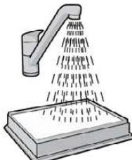
**5. Мытье моющегося выпускного фильтра** Промойте фильтр изнутри (грязную сторону) теплой водой из-под крана. Слегка постучите по рамке фильтра, чтобы стряхнуть воду. Повторите процедуру четырежды.
