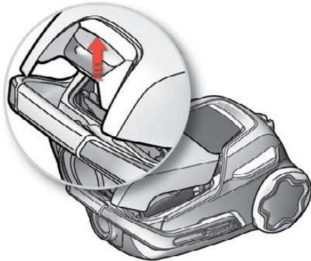
**3. Otevřete kryt prachového oddílu zatažením za tlačítko uvolnění sáčku „S-BAG“.**
