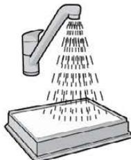
**5. Čišćenje perivog ispušnog filtra** Operite samo unutarnju (prijavu) stranu u tekućoj mlačoj vodi. Stresite okvir filtra da biste uklonili vodu. Postupak ponovite četiri puta.
