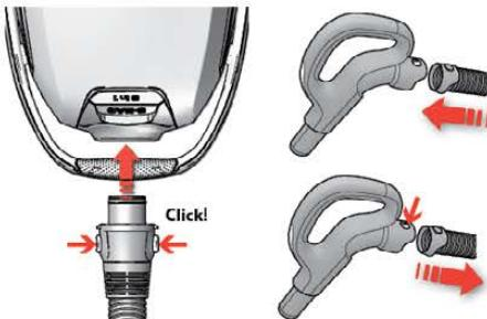
**2. Вставьте шланг в пылесос** (чтобы снять его, нажмите кнопки замка и вытяните шланг).
