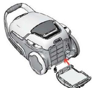
**7. Pokud se víčko filtru uvolní, opravte jej tak, že nastavíte spodní část se závěsem a zatlačíte na víčko filtru, dokud nezaklapne zpět na místo.**
