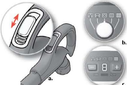
**9. Namiestite snagu usisa.** Modeli s ručním upravovaním. a) Za brzo smanjivanje protoka zraka upotrijebite tipku za upravljanje usisom na ručki b) Pomoću okretne tipke na usisavaču namiestite snagu usisa c) Pomoću tipke + ili - na usisavaču podesite snagu usisa.
