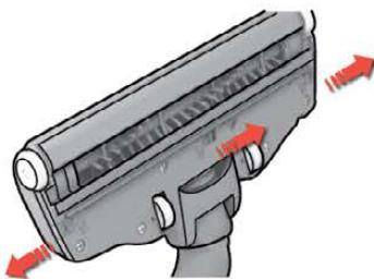
**1.** Otvorite poklopac valjka s četkom pritiskom na spojnice. Tako ćete osloboditi prednje kotačice za čiščenje.
