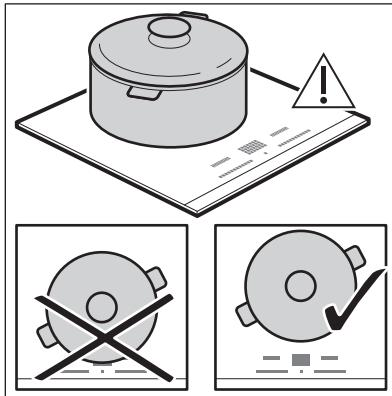
A főzőedényt a kiválasztott főzőzóna közepére helyezze. Az indukciós főzőzónának automatikusan alkalmazkodnak a főzőedény aljának méretéhez.
