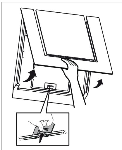
**4.2 Der NICHT waschbare Aktivkohlefilter** - Je nach der Benetzungsdauer des Herdes und der Häufigkeit der Reinigung des Fettfilters tritt nach einer mehr oder weniger langen Benutzungsduer die Sättigung des **Aktivkohlefilters** auf. Auf jeden Fall muß der Filtereinsatz mindestens alle 4 Monate ausgewechselt werden. Er kann NICHT gereinigt oder erneut aktiviert werden.
