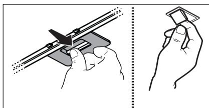
**4.2 Der NICHT waschbare Aktivkohlefilter** - Je nach der Benutzungsdauer des Herdes und der Häufigkeit der Reinigung des Fettfilters tritt nach einer mehr oder weniger langen Benutzungsdauer die Sättigung des **Aktivkohlefilters** auf. Auf jeden Fall muß der Filtereinsatz mindestens alle 4 Monate ausgewechselt werden. Er kann NICHT gereinigt oder erneut aktiviert werden.
