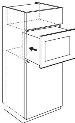
4. Abra a porta e fixe o aparelho ao móvel com o parafuso.
