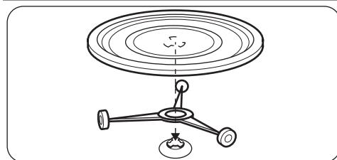
1. Vodicí lištu válečků položte okolo hřídele otočného talíře.
