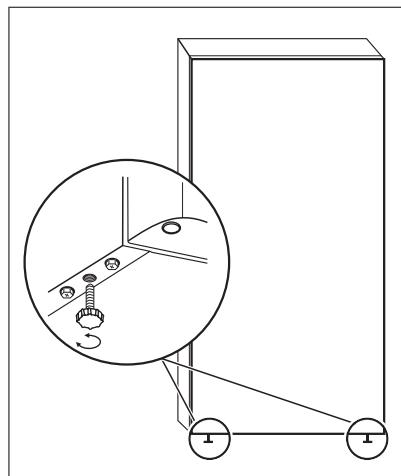
W trakcie ustawiania urządzenia należy zwrócić uwagę, aby było ono prawidłowo wypoziomowane. Służą do tego dwie regułowane przednie nóżki.
