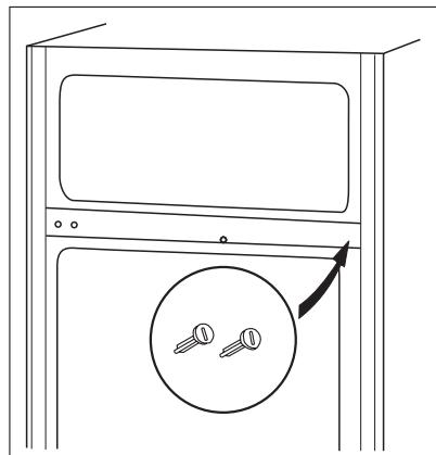
5. Vyšroubujte obě seřiditelné nožičky a šrouby dolního dveřního závěsu. Odstraňte dolní dveřní závěs a instalujte ho na opačné straně.
