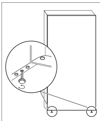
Po umístění spotřebiče zkонтролуйте, zda stojí rovně. Můžete ho vyrovnat seřízením dvou dolních předních nožiček.
