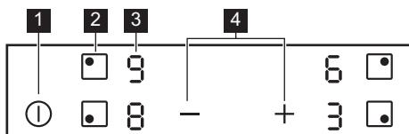
Folosiți câmpurile cu senzori pentru controlul aparatului. Afisajele, indicatoarele și semnalele sonore indică funcțiile active.
