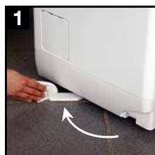
1 K přemístění pračky stačí zatáhnout za páku u dna pračky a otočit ji zprava doleva; tím se pračka postaví na kolečka. Po přemístění pračky na zvolené místo páku opět vraťte do původní polohy.
