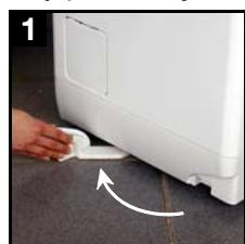
Aby przesunąć pralkę należy ustawić ją na kółeczkach przesuwając zdecydowanie dźwignię znajdującej się u dołu urządzenia z prawej strony w lewo. Gdy urządzenie jest już na właściwym miejscu, przesunąć dźwignię z powrotem na początkową pozycję.
