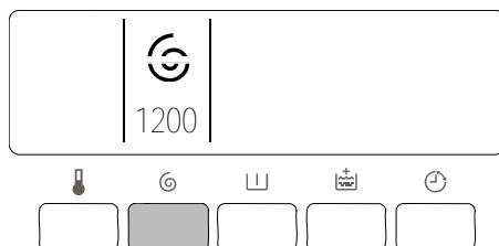
Pokud chcete prádlo odstředit při jiné rychlosti odstředění, než nabízí pračka, stiskněte tlačítko "Odstředění" . Můžete také zvolit funkce "Bez odstředění" , "Zastavení s vodou v bubnu" nebo "Noční klid plus" (\*). Maximální rychlosti jsou : pro Bavlnu, Eco : 1300 ot/min, pro Džíny : 1200 ot/min, pro Vlna, Ruční praní : 1000 ot/min, pro Syntetické, Snadné žehlení, Dámské spodní prádlo, Sport : 900 ot/min, pro Jemné, Hedvábí : 700 ot/min.
