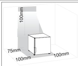
Međutim, u savršenim se uvjetima uređaj ne bi smio nalaziti ispod visećih zidnih elemenata. Točno niveliranje osigurava se pomoću jedne ili više podesivih nožica na podnožju kućišta uređaja.
