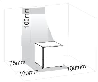
Najlepiej jednak nie ustawiać urządzenia pod wiszącymi szafkami. Urządzenie można dokładnie wypoziomować dzięki regulowanym nóżkom.
