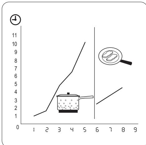
Mit der Ankochautomatik wird die erforderliche Kochstufe in kürzerer Zeit erreicht. Bei Verwendung dieser Funktion wird eine gewisse Zeit lang die höchste Kochstufe (siehe Abbildung) eingestellt und anschließend auf die erforderliche Stufe zurückgeschaltet.
