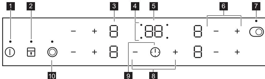
Bedienen Sie das Gerät über die Sensorfelder. Anzeigen, Kontrolllampen und akustische Signale informieren Sie über die aktiven Funktionen.
