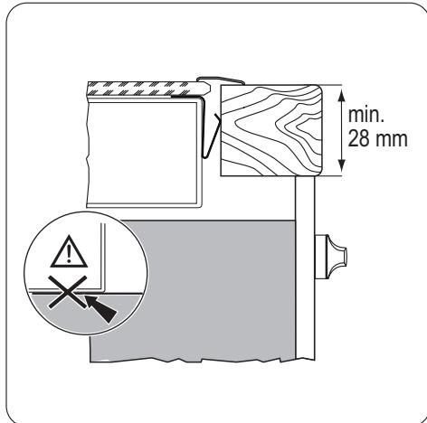
**i** Si vous utilisez une enceinte de protection (accessoire en option<sup>3)</sup>), le fond de protection installé directement sous l'appareil n'est plus nécessaire. Vous ne pouvez pas utiliser le boîtier de protection si vous installez l'appareil au-dessus d'un four.
