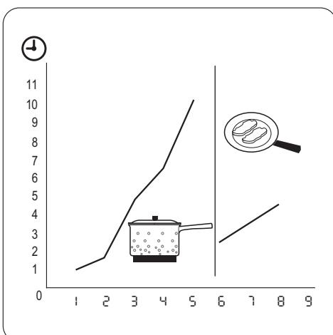
La fonction Démarrage automatique de la cuisson permet d'atteindre plus rapidement le réglage de température souhaité. Cette fonction active la température la plus élevée pendant un certain temps (voir l'illustration) puis redescend à la température sélectionnée.
