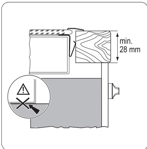
**i** W przypadku zastosowania kasety ochronnej (wyposażenie dodatkowe<sup>3)</sup>), zastosowanie osłony bezpośrednio pod urządzeniem nie jest konieczne. W przypadku montażu urządzenia nad piekarnikiem nie można użyć kasety ochronnej.
