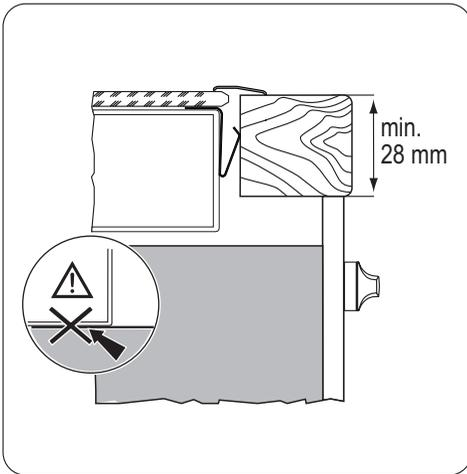
**i** Αν χρησιμοποιείτε προστατευτικό πλαίσιο (πρόσθετο εξάρτημα<sup>1)</sup>), το προστατευτικό δάπεδο ακριβώς κάτω από τη συσκευή δεν χρειάζεται. Δεν είναι δυνατή η χρησιμοποίηση του προστατευτικού πλαισίου εάν εγκαταστήσετε τη συσκευή επάνω σε φούρνο.
