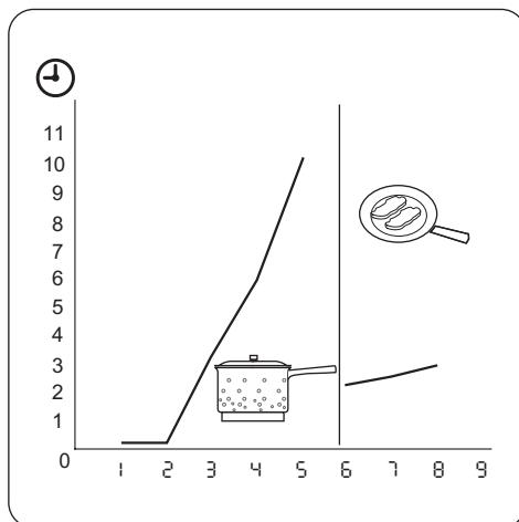
Nepieciešamo sildīšanas pakāpi var sasniegt ātrāk, aktivizējot automātiskās uzsildīšanas funkciju. Šī funkcija uz laiku (skatiet grafiku) iestata augstāko sildīšanas pakāpi un pēc tam samazina temperatūru līdz vajadzīgajai sildīšanas pakāpei.
