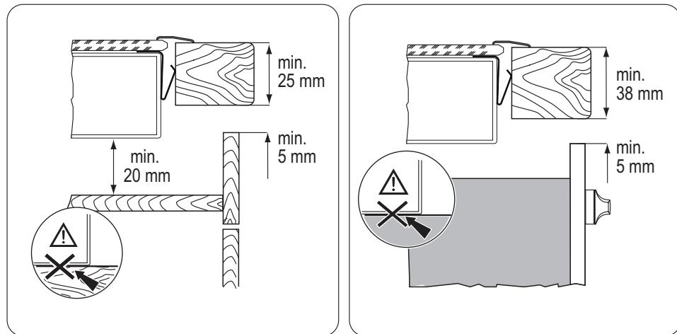
**i** Pokud používáte ochrannou skříň (doplňkové příslušenství<sup>1)</sup>), není nutné zachovat přední prostor pro proudění vzduchu o šířce 5 mm a instalovat ochranné dno přímo pod spotřebičem.
