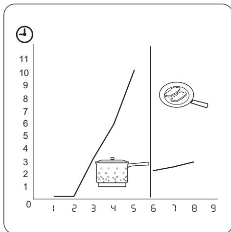
Ijungus automatinio įkaitinimo funkciją, reikiamas įkaitinimas pasiekiamas per trumpesnį laiką. Ijungus šią funkciją, tam tikram laikui nustatoma didžiausia įkaitinimo temperatūra (žr. pav.), o vėliau ji mažinama iki reikiamas temperatūros.
