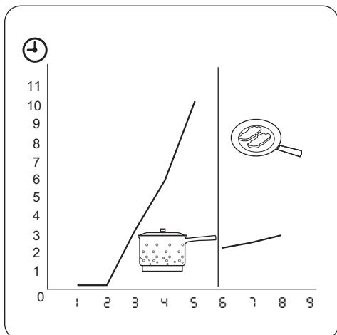
Pokud zapnete funkci automatického ohřevu, můžete potřebné teploty dosáhnout za kratší dobu. Tato funkce nastaví na určitou dobu nejvyšší teplotu (viz obrázek) a pak ji sníží na požadované nastavení teploty.
