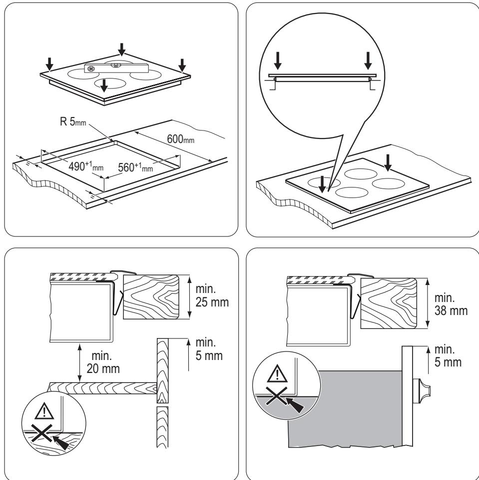
**i** W przypadku zamontowania kasety ochronnej (wyposażenie dodatkowe<sup>5)</sup>), nie ma konieczności pozostawienia 5 mm przestrzeni wentylacyjnej z przodu, jak również montażu przegrody zabezpieczającej bezpośrednio pod urządzeniem.
