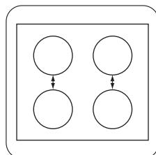
Řízení výkonu rozděluje výkon mezi dvě párové varné zóny (viz obrázek). Funkce zvýšení výkonu nastaví maximální teplotu jedné varné zóny z páru. Automaticky také sníží výkon druhé varné zóny. Displej varné zóny se sníženým výkonem se mění v rozmezí dvou úrovní.
