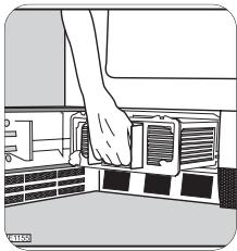
3. Para esvaziar o permutador térmico, segure-o na vertical sobre o lava louça. Limpe-o com uma escova e enxague eventualmente com o duche de mão. Limpe também a parte exterior retirando o cotão. Limpe as guarnições ao redor do condensador e no interior da portinha com um pano húmido.
