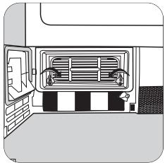
2. Limpar o interior da porta e o compartimento do permutador térmico de cotão. Esfregar a vedação da porta com um pano húmido. Segurar o permutador térmico pela pega para retirá-lo do suporte e transportá-lo na horizontal para evitar que a água residual derrame.
