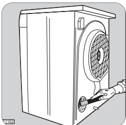
Vlakna z rešetke vstopa zraka, ki se nahaja na hrbtni strani sušilnika, očistite s sesalnikom za prah.
