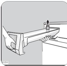
2. e levantar o tubo de descarga do recipiente da água de condensação até ao batente.
