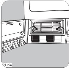
**2.** Med in po sušenju je normalno, da se na površini vložka kondenzatorja nahaja voda.
