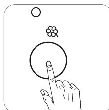
Ennek a gombnak a megnyomása lehetővé teszi, hogy kényes ruhadarabok esetén a száritás alacsonyabb hőmérsékleten történjen. A megfelelő jelzőfény felgyullad. Ez az opció idővezérelt száritás esetén is használható. ALACSONY HŐFOK csak legfeljebb 3 kg töltet esetén érdemes megnyomni.
