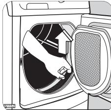
Se necessário, os filtros podem ser lavados com água corrente utilizando uma escova. Neste caso remova o filtro do óculo como demonstrado na figura (pode ser posicionado com a patilha virada para a esquerda ou para a direita).
