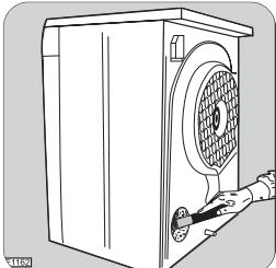
Limpe com cuidado a grade de aspiração traseira usando um aspirador de pó.
