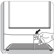
**1.** Kondenzacijsko enoto očistite, ko se prižge lučka (Čiščenje kondenzatorja).
