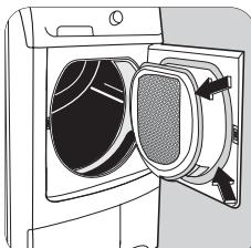
Limpe periodicamente o interior da porta e retire todo o cotão que se junta à volta do filtro.
