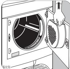
Não se preocupe pela quantidade de cotão no filtro. Isso não é devido a um consumo excessivo da roupa causado pelo secador. Todas as fibras perdem pelinhos durante a secagem, mas, enquanto não é possível reparar neste fenômeno quando se verificar ao ar livre, na secagem com a máquina todos os pelinhos se recolhem no filtro.
