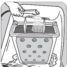
**4.** Očistite ga s krtačo in po potrebi izperite s tušem. Očistite tudi zunanjost in odstranite vsa vlakna.
