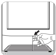
1. O acendimento do indicador (limpeza condensador) indica que o condensador deve ser limpo. O condensador é situado na parte inferior do aparelho, atrás de uma portinha. Para abri-lo, carregue na tecla da maneira indicada na figura.
